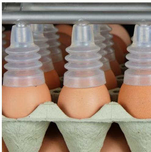
El sujetador, con el uso de ventosas de goma y vacío acumulado, agarra los huevos lo que permite su transporte. Permite trasladar los huevos de los cartones a la máquina en una sola operación.
